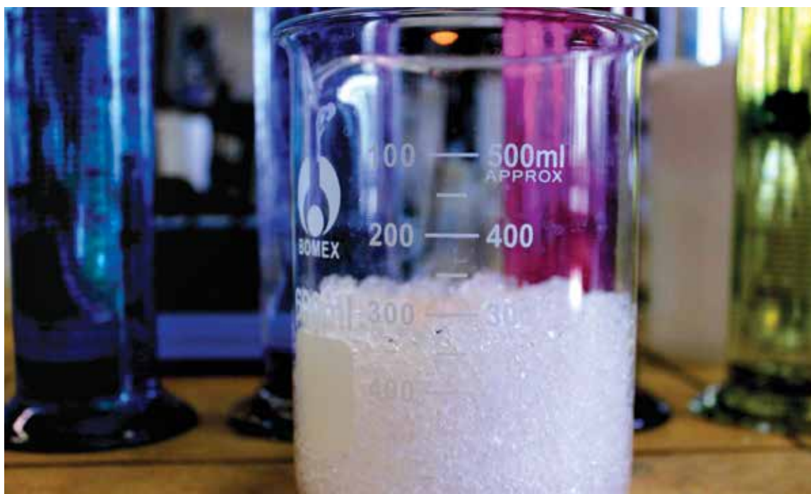
Naukowcy zastosowali polimery, które pod wpływem kontaktu z wodą zwiększają swoją objętość nawet do 400 razy
