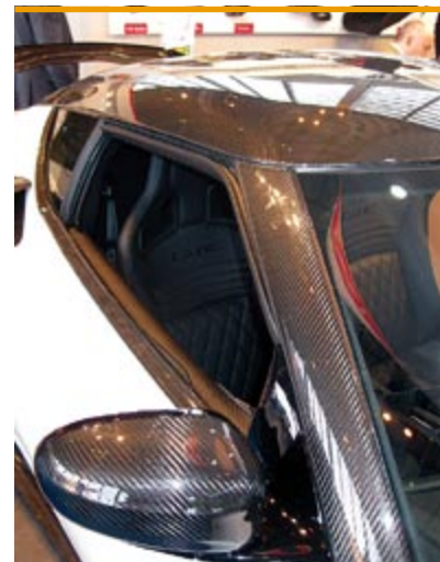
Samochód sportowy LOTUS wykonany w znacznym stopniu z kompozytów węglowych
