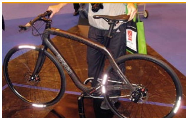
Technologiczna rama rowerowa wykonana techniką wyplatania
