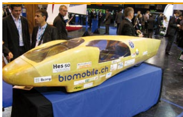
Pojazd pełnoekologiczny – karoseria wykonana z kompozytowych materiałów biodegradowalnych; zasilanie biogazem
