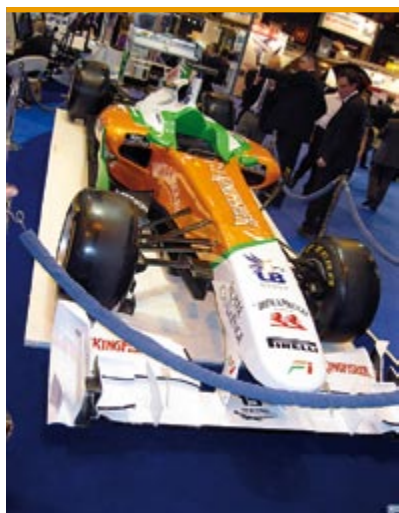
Bolid wykonany z kompozytów węglowych; widoczne na zdjęciu także elementy zawieszenia
