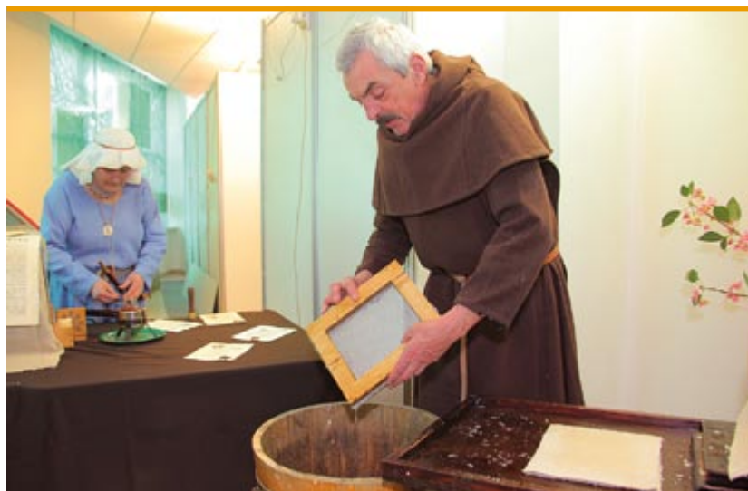
Proces czerpania papieru z dębowej kadzi papierniczej i odciskanie pieczęci lakowych w wykonaniu fachowców z Czerpalni Papieru ART-PAPIER z Glitwic
