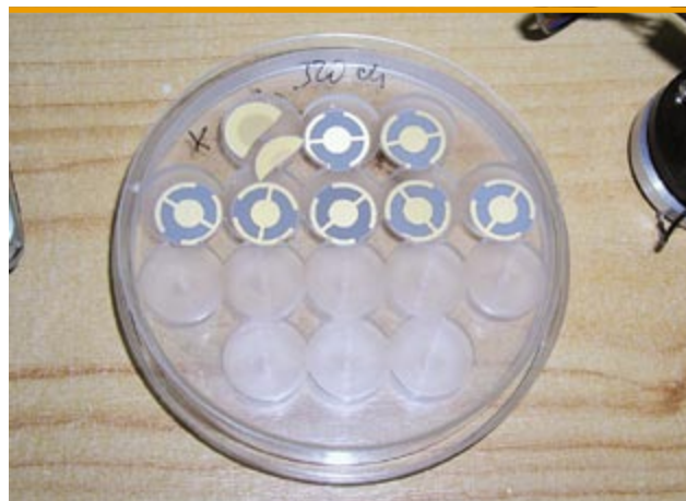
Piezodyski jako sensory czujników wykonane w zespole prof. T. Gotschalka
