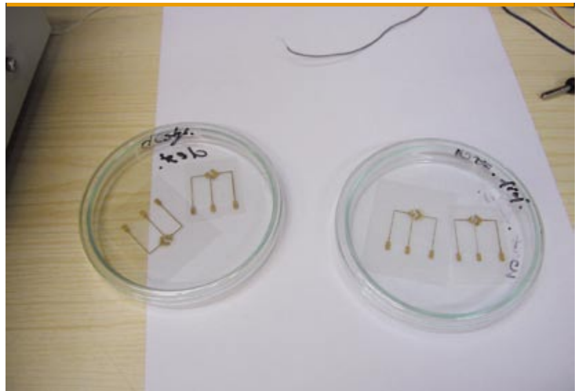
Czujniki impedancyjne wykonane w zespole prof. T. Traczeńskiej mają elektrody pomiarowe o rozwidlonym kształcie
