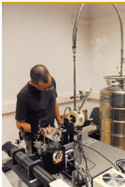
Układ do spektroskopii optycznej pojedynczych kropek kwantowych
