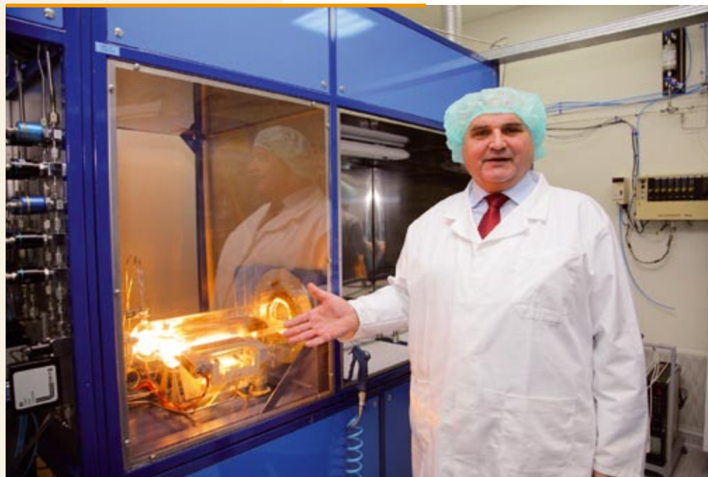
Stanowisko do epitaksji heterostruktur AIIIIV metodą MOVPE (epitaksja z fazy gazowej wykorzystująca związki metaloorganiczne) prezentuje prof. M. Tłaczała
