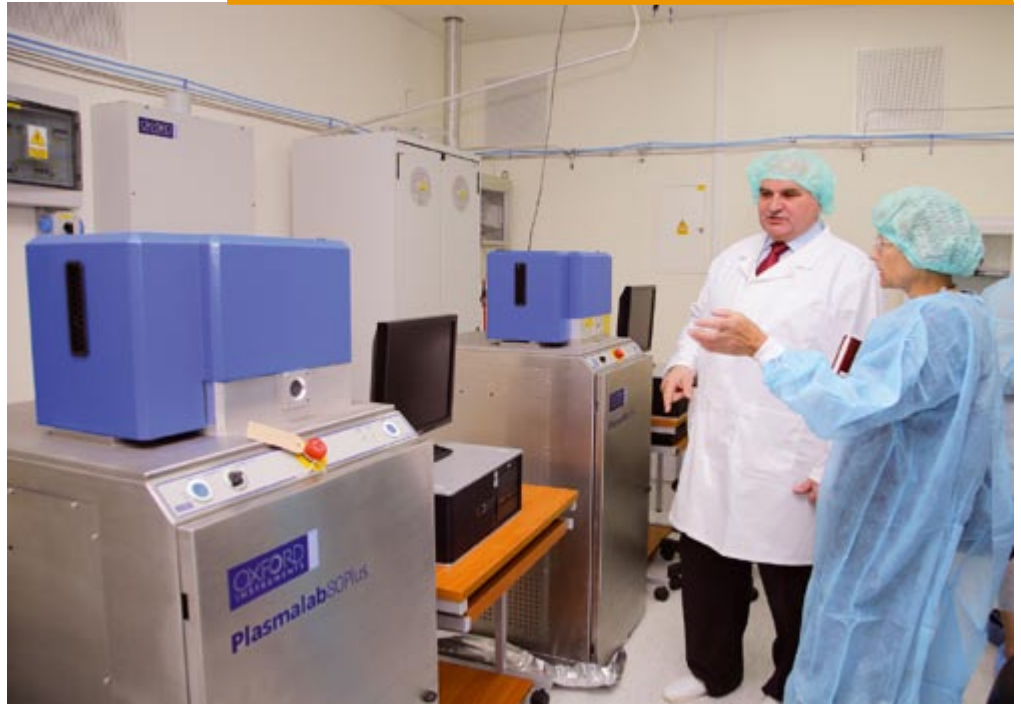
M. Tłaczala z dumą prezentuje nowe nabytki do laboratorium: bliźniacze urządzenia do nanoszenia warstw dielektrycznych PECVD i do trawienia plazmowego RIE Plasmalab 80Plus firmy Oxford Instruments
