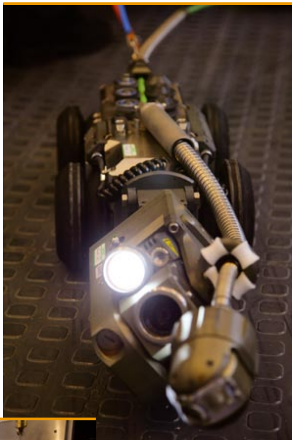
„Szczur w kanale”, czyli kamera CCTV
