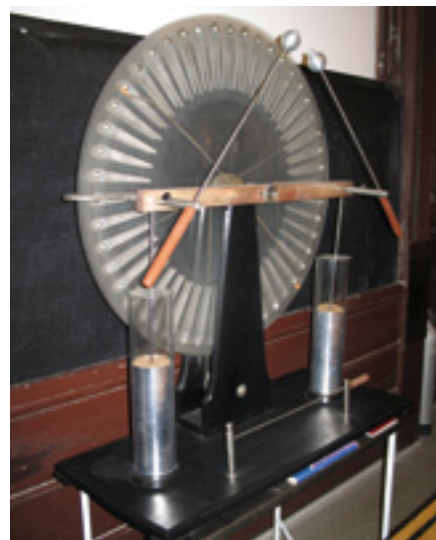
Maszyna do wytwarzania ładunków elektrycznych (prawdopodobnie największa we Wrocławiu) znajdująca się w Instytucie Fizyki.
