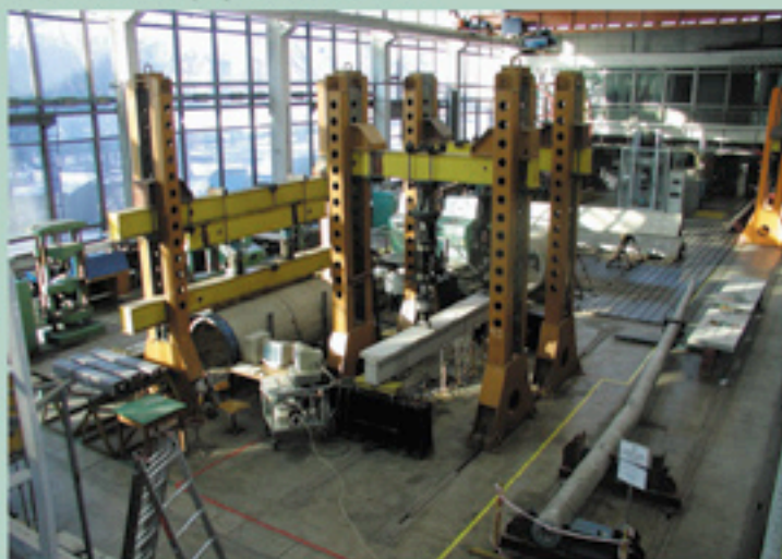
Widok ogólny laboratorium. Po prawej niszczona żerdź energetyczna.
