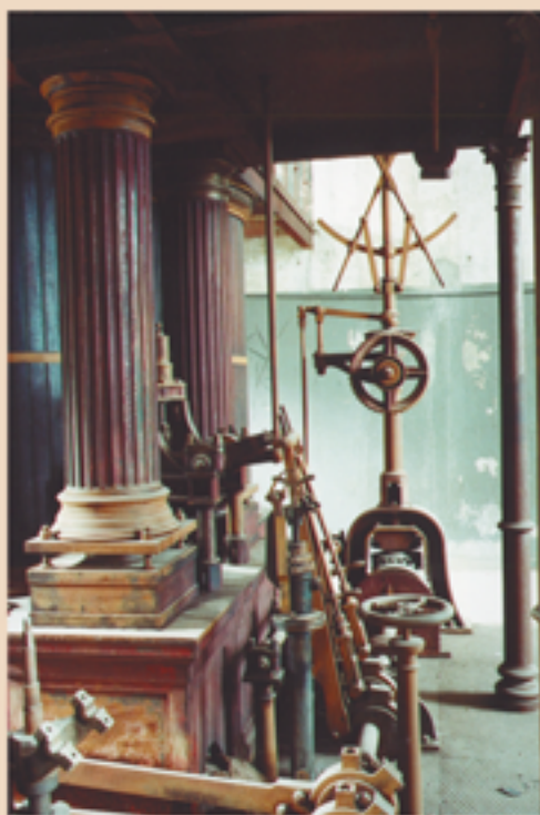
Zawory pary na tle cylindrów maszyny parowej
