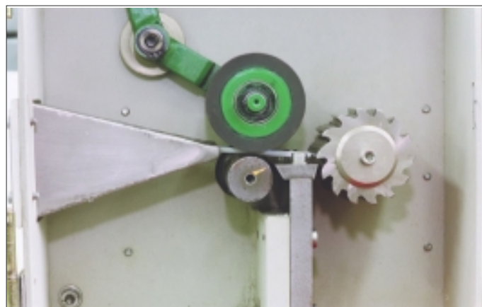
Element linii technologicznej – granulator frezowy. Przetworzony materiał ulega tu rozdrobnieniu.
